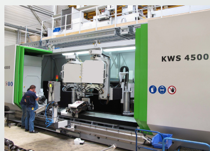
Grinding/polishing unit 1 & 2 Doors open completely for crane loading. Schleif- und Polieraggregat 1 & 2 Türen komplett öffnend für Kranbeladung.
