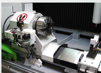
Hydraulic work piece fixture and hydrostatic support. Hydraulische Werkstückspannung und hydrostatische Lünette.
