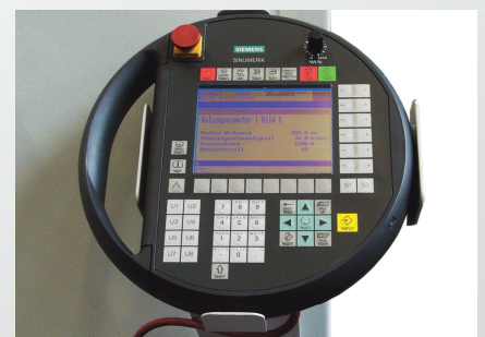
Manual control unit Siemens HT 8. Mobiles Handbediengerät Siemens HT 8.
