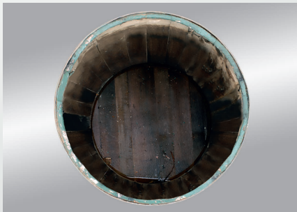
Cask before skiving/grinding. Fass vor dem Raspeln.
