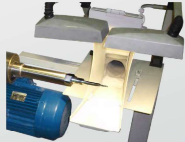
Sonderpoliermaschine für Turbinenschaufeln Special polishing machine for turbine blades
